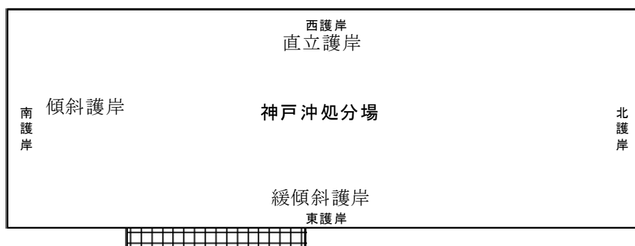
図 4-1 神戸沖埋立処分場 護岸配置
