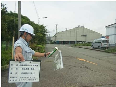
搬入基地における悪臭測定
