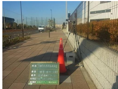
搬入基地沿道における騒音・振動測定
