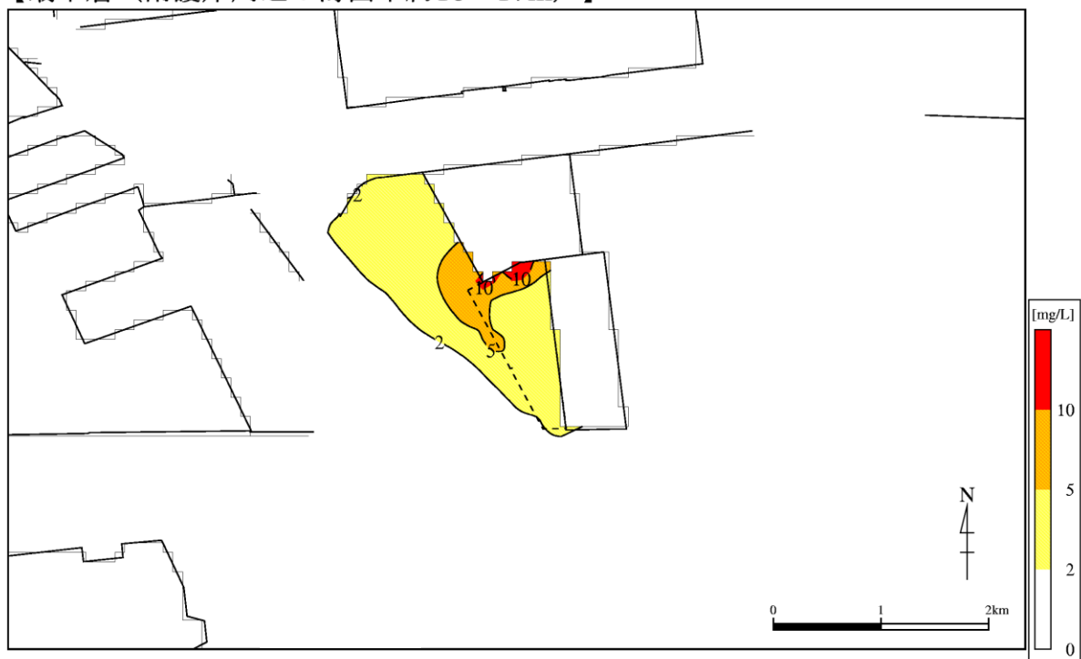
第 4.3.1-3 図 (2) 護岸等の施工に伴う SS 寄与濃度の予測計算結果（最大濃度） （最下層）
