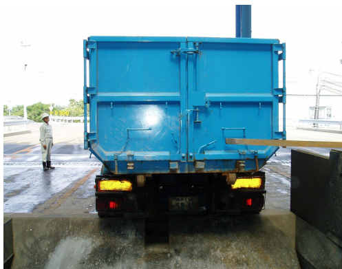
× 車両後方でのロック解除が危険
