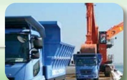
基地から船で運んできた廃棄物や土砂は油圧ショベルを使って船からダンプトラックに移します。
